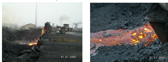
Figure 1.2 : Déversement de la scorie du cuvier dans le bassin de refroidissement.
