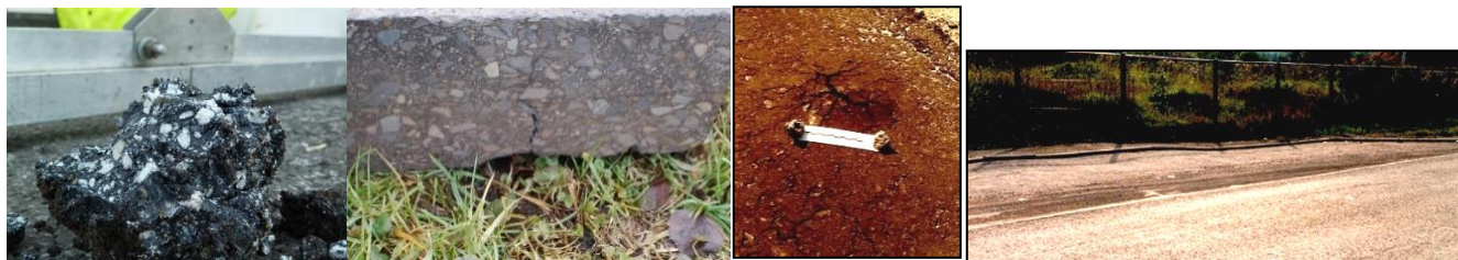
Figure 3.1 : Exemples de gonflements de scorie dû à la présence de chaux ou de magnésie.
