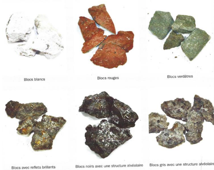
Figure 3.8 : Différents faciès et couleurs des scories de manganèse et de molybdène (source : BRGM).
