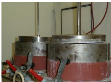
Figure 3.2 : Vue et schéma du dispositif de l'essai de gonflement accéléré.
