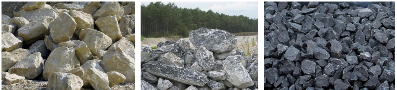
Figure 2.10 : Exemples de calcaires. De gauche à droite, calcaire blanc ou clair – calcaire gris – calcaire bleu (source : internet).
