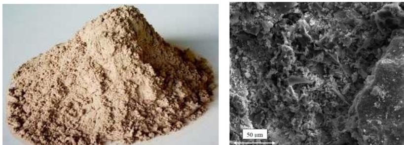
**Figure 2.9** : Détails visuel et microscopique d'une cendre volante calcique (Sources : AC Presse et Ayriinhac (2005)).
